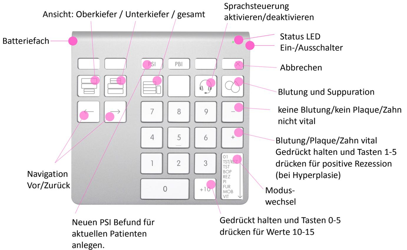
Nach einem Batteriewechsel bitte den Ein-/Ausmacher kurz drücken bis die Status LED grün leuchtet. Sobald die LED wieder erlischt kann die Tastatur benutzt werden.
